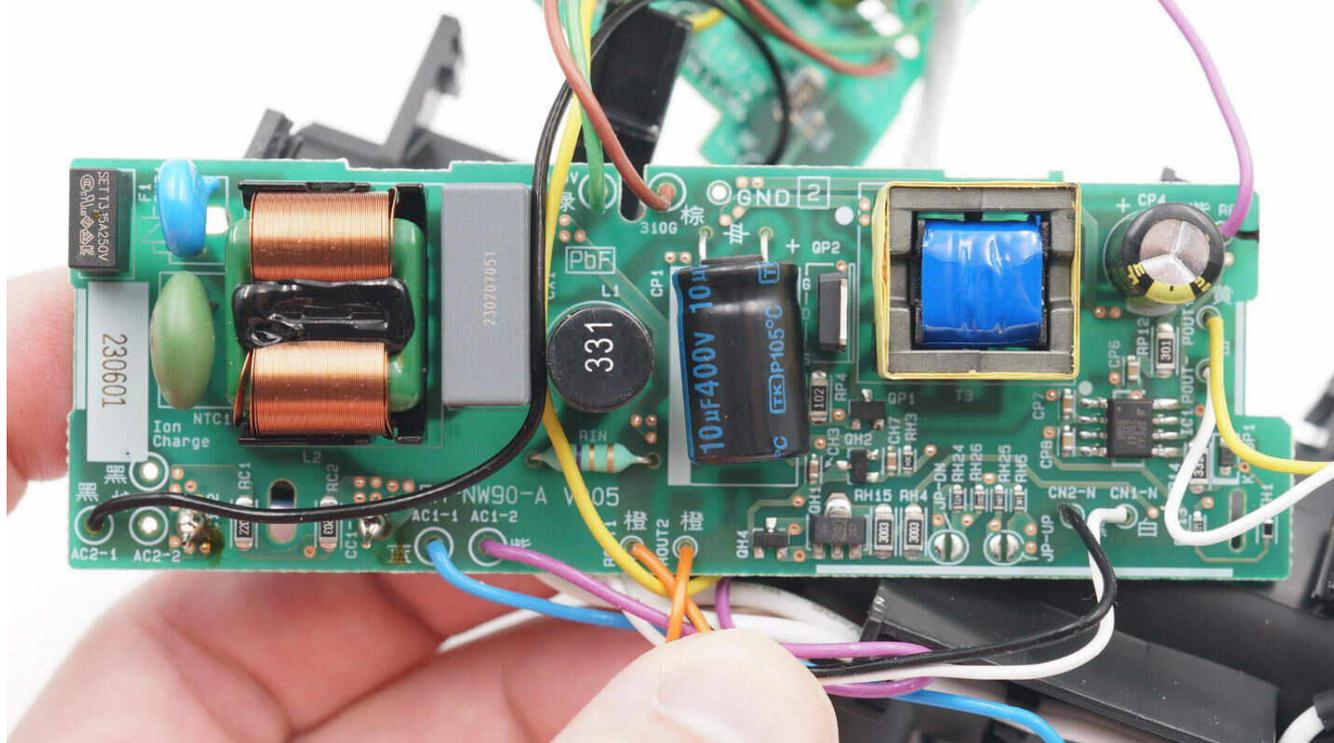
电源板正面一览，左侧设有保险丝，NTC热敏电阻，压敏电阻，共模电感，安规X2电容。右侧设有滤波电感，高压滤波电容，变压器和低压滤波电容。
