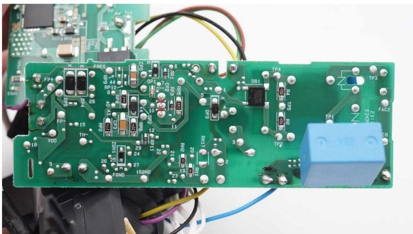
PCBA模块背面设有安规X2电容，整流桥和整流二极管。
